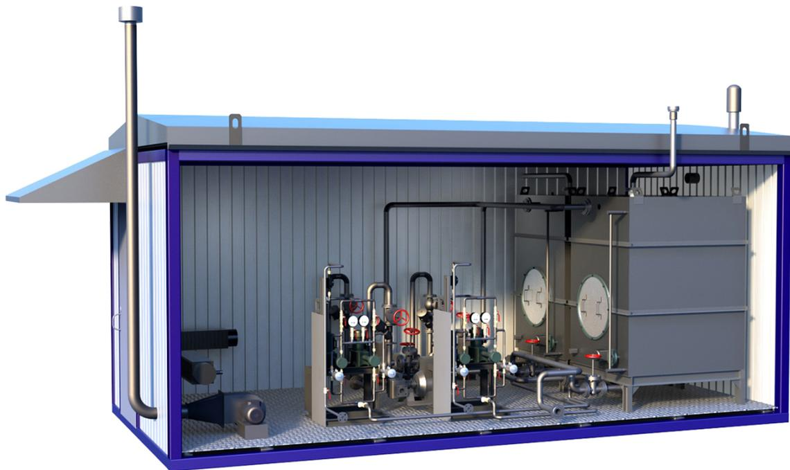
Блок для дозирования реагентов БР-25 предназначен для приготовления, а также дозирования чистых деэмульгаторов и ингибиторов коррозии и может устанавливаться на групповых замерных установках или установках по подготовке нефти. Блок БР-25 состоит из рамы-саней, теплоизолированной будки, технологической емкости, шестеренного насоса РЗ-4,5а, плунжерного дозировочного насоса НД-0,5Р-2,5/400, электрообогревателей, вентилятора, запорно-регулирующей арматуры, системы контроля и управления.
