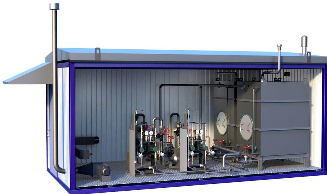
Блок для дозирования реагентов БР-2,5 предназначен для приготовления, а также дозирования чистых деэмульгаторов и ингибиторов коррозии и может устанавливаться на групповых замерных установках или установках по подготовке нефти. Блок БР-2,5 состоит из рамы-саней, теплоизолированной будки, технологической емкости, шестеренного насоса РЗ-4,5а, плунжерного дозирочного насоса НД-0,5Р-2,5/400, электрообогревателей, вентилятора, запорно-регулирующей арматуры, системы контроля и управления.
