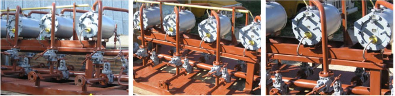
Групповые замерные установки ГЗУ-Дельта предназначены для непрерывного измерения количества жидкости (массовым методом) одновременно во всех подключенных скважинах и оперативного контроля за работой нефтяных скважин по их дебиту.
